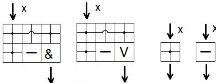
Рис. 2. Схемы, реализующие функции одной переменной
